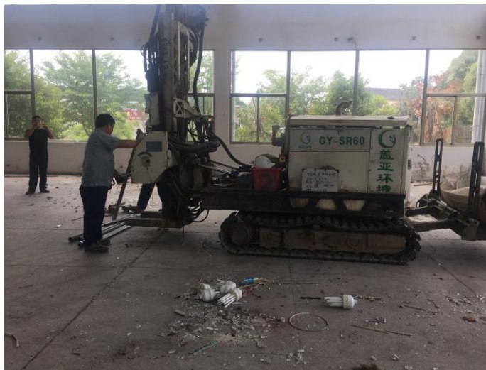
图 5-2 盖亚 GY-SR90 钻机示意图
