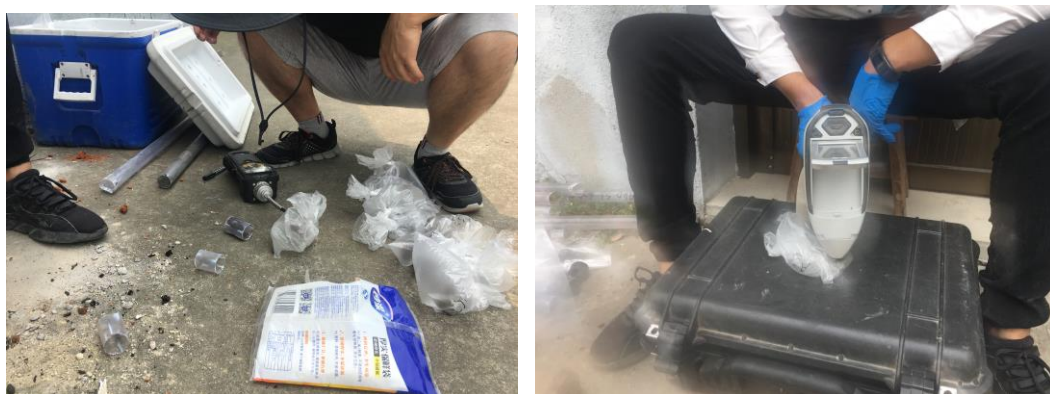
图 5-8 手持式 PID 及检测（左）与 XRF 检测（右）
