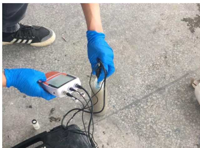
图 5-9 地下水水质现场检测
