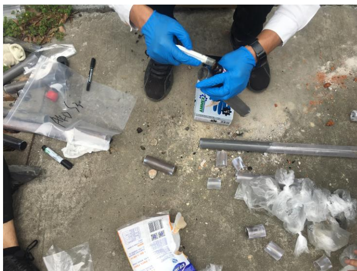
图 5-7 土壤 VOCs 样品采集
